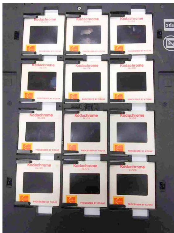
Fig. 36. Diapositivas colocadas en plantilla para su digitalización.
